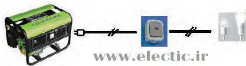
شکل ۱۶. مدار ساده اتصال یک ژنراتور گازسوز به مصرف کننده
